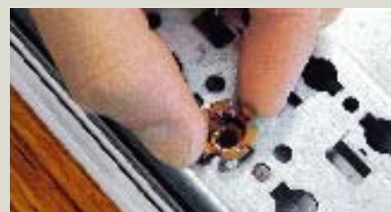
Deux clips-écrous (fournis) suffisent pour tenir toutes les versions de platines
