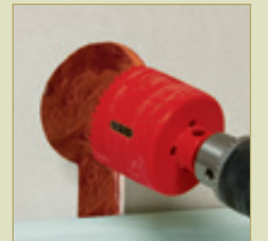
Perçage à la scie cloche Ø67 mm
