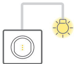
Interrupteur témoin : le voyant signale que l'éclairage est allumé.
